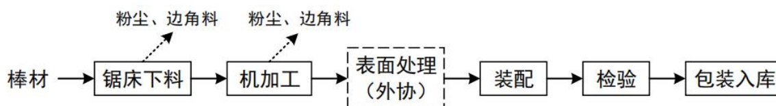
图2-3 联轴器生产工艺流程
