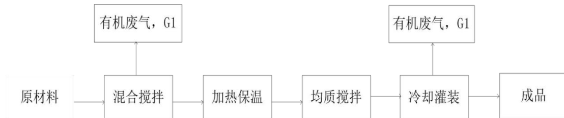
图 2-2 本项目实际生产工艺流程和产污环节图
